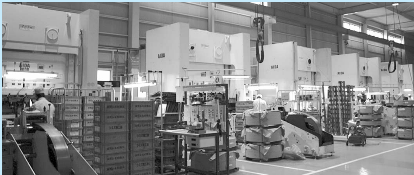
▲トランスファープレスNCS-300トン、NS2-300トン 5台ライン
