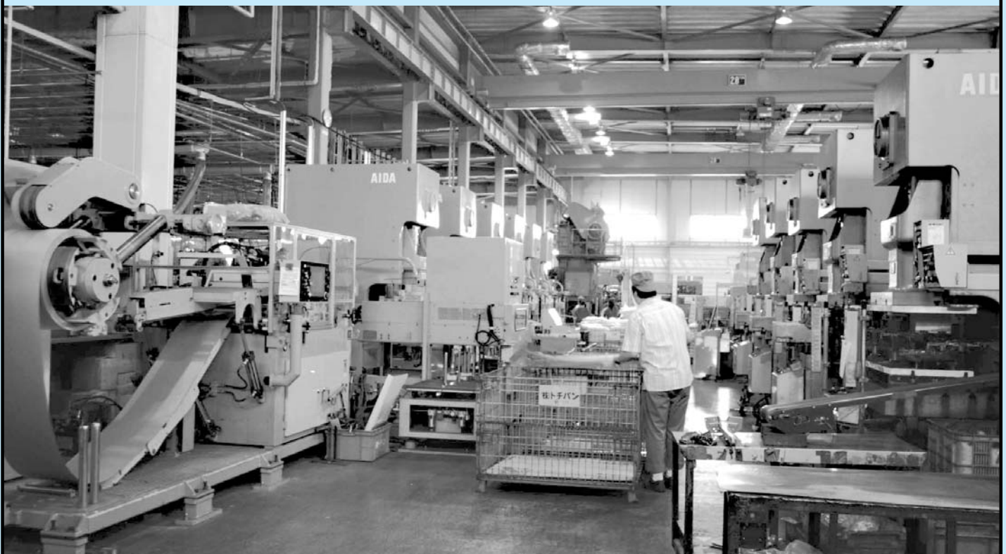
▲左 NC-1 150トン A-8ロボット 6台ライン LFG-600E、高速搬送対応NCブランクフィーダ付き 右 NC-1 150トン A-8ロボット 6台ライン
