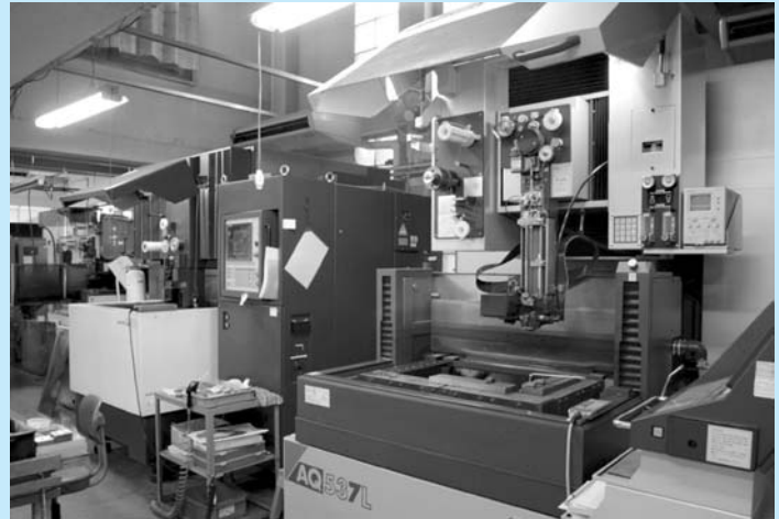
▲ワイヤーカット放電加工室
