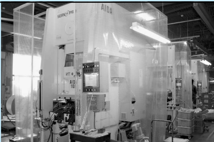
▲ダイレクトサーボフォーマNS1-110トン、80トン4台順送ライン
