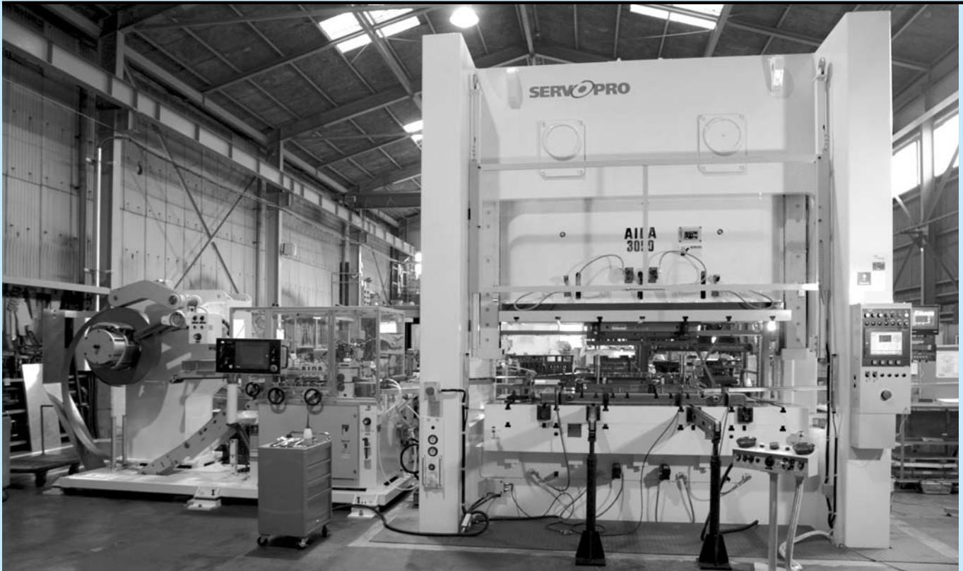
▲ダイレクトサーボフォーマ 順送ライン NS2-3000D (300トン) +LFG-400E (400幅)
