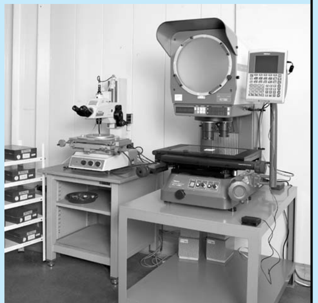
▲工具顕微鏡と投影機が並ぶ検査室
