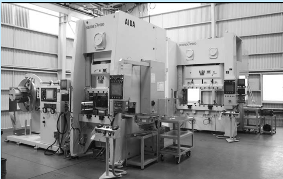
▲ダイレクトサーボフォーメ NS1-110トン 手前、NS2-160トン 奥
