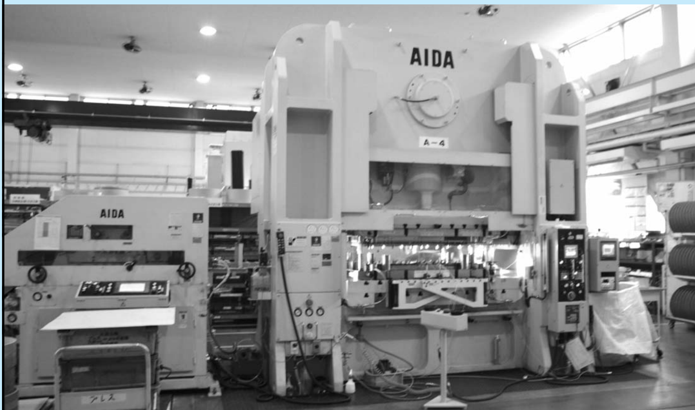
▲精密成形機 UL-3000 + レベラフィーダLFG付 加工ライン
