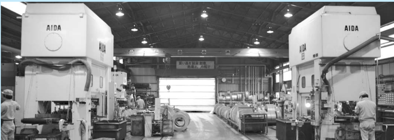
▲リンクモーションプレスPMX-300トン ロールフィード付順送ライン
