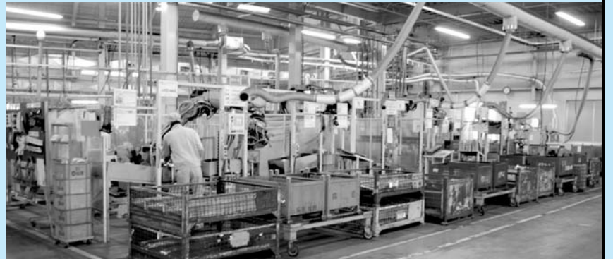
▲スポット溶接ライン
