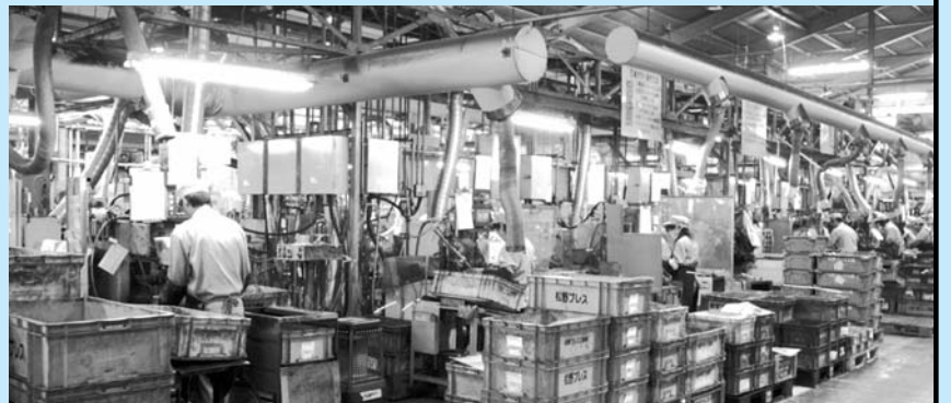
▲スポット溶接ライン
