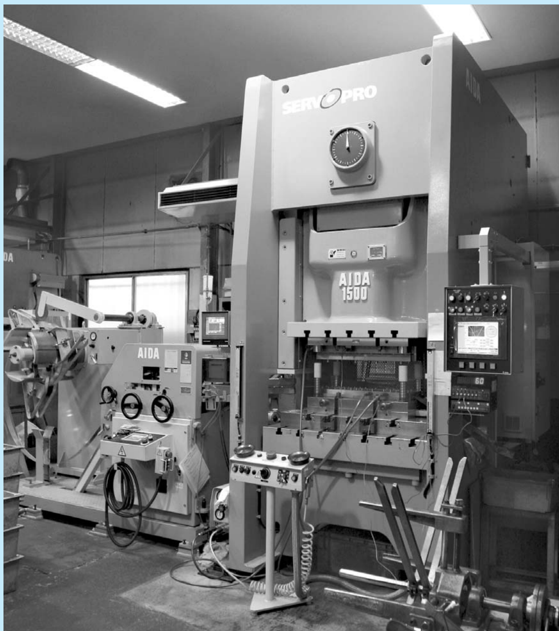
▲ダイレクトサーボフォーマNS1-150トン+レベラーフィーダLFL-300E
