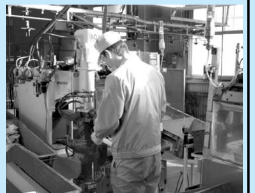
▲リベットとスポットの1ライン化工程
