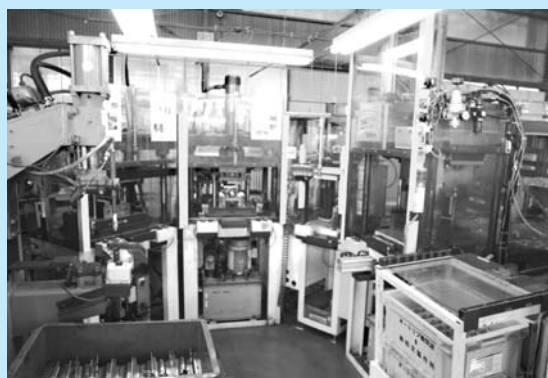
▲組付け5工程を1ユニット化で処理
