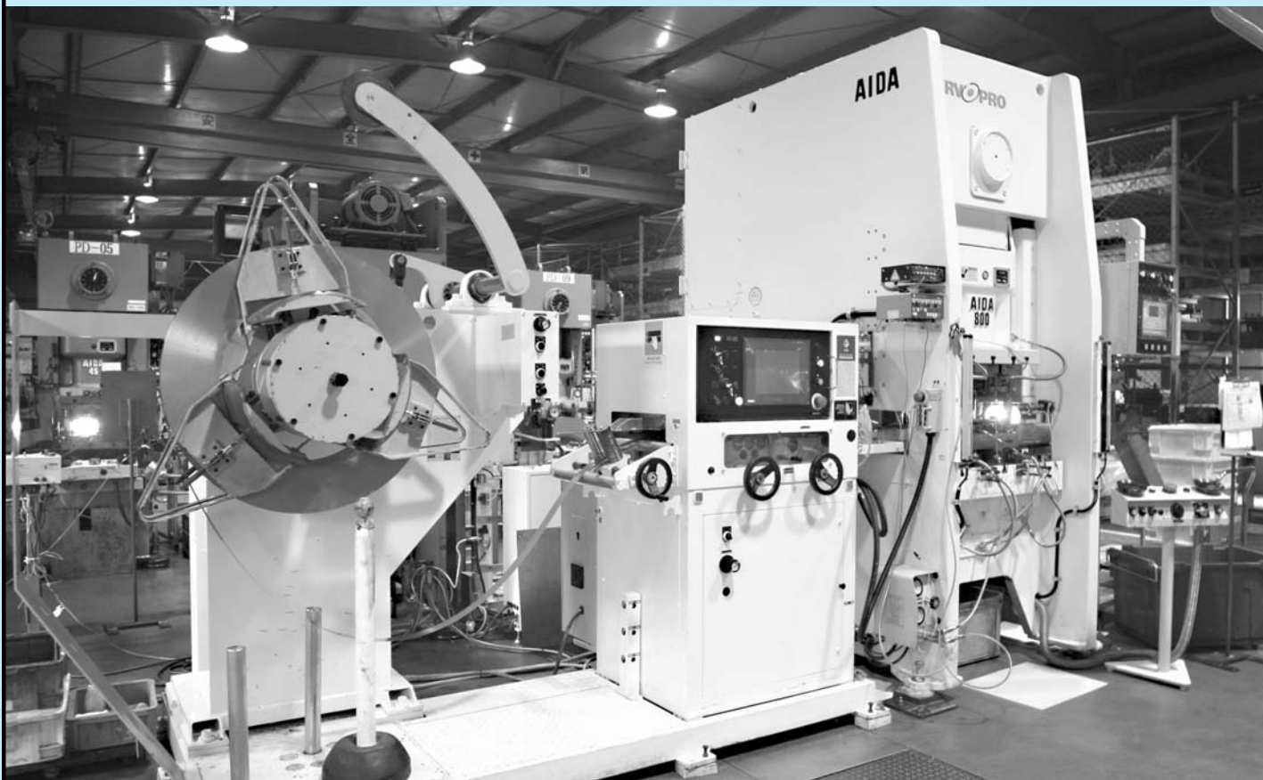
▲ダイレクトサーボフォーマNS1-80トン+レベラーフィーダLFL-300E
