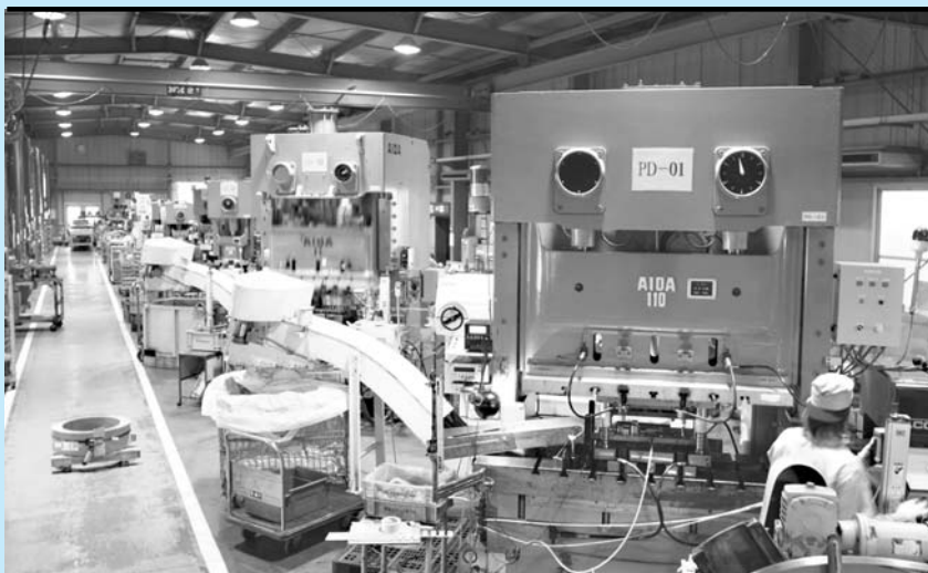
▲第3工場のNC2-110トン～NC1-60トン7台による高速精密プレスライン
